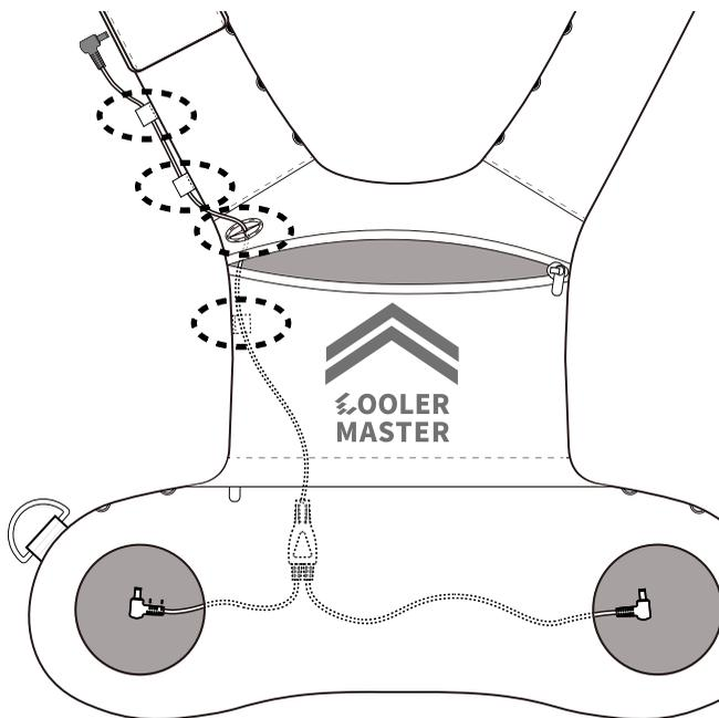
図に示された通りに、ケーブルを指定された位置に取り付けます。
