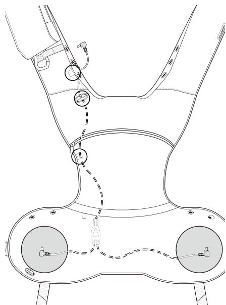
ケーブルを○で示されたケーブル固定ループを通します。（点線の部分を保冷スペース開口部を通して保冷スペースの中に入れてください。）
