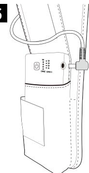
ケーブルの端子をバッテリーOUTPUT端子に接続します。
