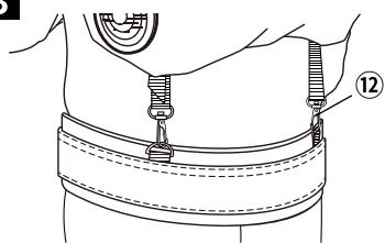
可動式吊り下げベルトナスカン⑫をサポートベルトのDカンなどに取り付けます。
